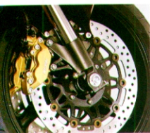
Für zuverlässige Verzögerung sorgen gewaltige 330-mm-Ö-Doppelscheibenbremsen.
