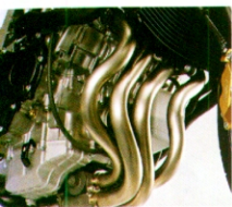
Die 4-in-2-in-1-Auspuffanlage ist zu großen Teilen aus Titan gefertigt.
