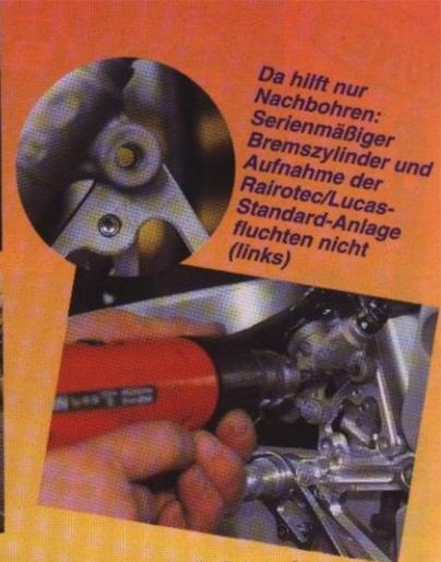
Da hilft nur Nachbohren: Serienmäßiger Bremszylinder und Aufnahme der Rairotec/Lucas-Standard-Anlage fluchten nicht (links)
