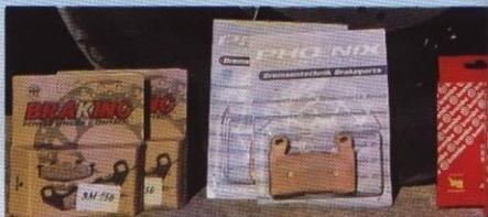
**Organische Bremsbeläge (von links): Braking SM (für die alten Zangen geliefert), Phoenix (Pagid) RS 11-337, Brembo 07**
