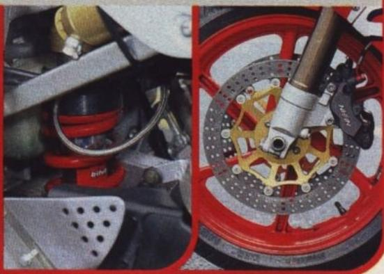
Längenverstellbares Bitubo-Federbein für größere Schräglagenfreiheit. Brachial: Bremsmix à la Fischer
