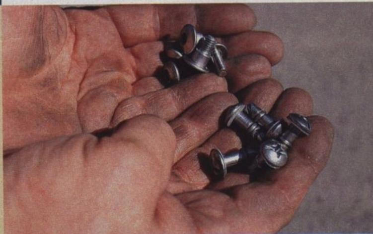
**Sparmaßnahmen im Detail: pifffige Verkleidungs-Schnellverschlüsse am 1992er-Modell, mühsames Schrauben an der aktuellen CBR 900 RR**
