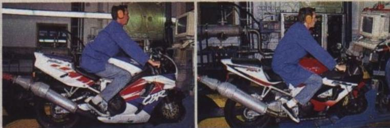
Auf dem Abgasprüfstand des TÜV wurden beide Honda auf Schadstoffwerte überprüft. In drei unterschiedlichen Testzyklen zeigte sich deutlich, dass der geregelte Katalysator der 2000er-Fireblade in allen Fahrzuständen eine deutliche Reduzierung der Schadstoffe bewirkt, speziell der Kohlenwasserstoffe (HC) und der Kohlenmonoxide (CO). Die Werte geben den Schadstoffausstoß in Gramm pro gefahrenem Kilometer an.
